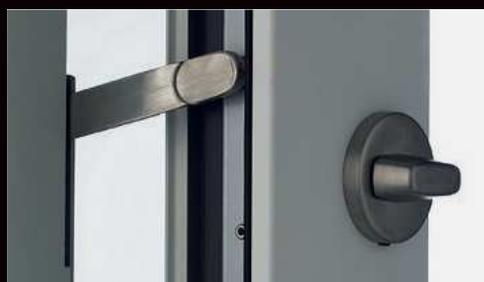
Die **Türsperre TSH** dient als Öffnungsbegrenzung. Sie wird aussen über das Hauptschloss betätigt (kein Zylinder aussen). Die Betätigung innen erfolgt über einen Drehknopf.
